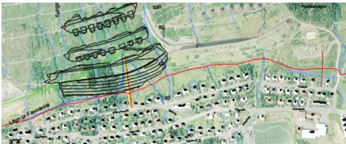
Mynd 23 Hluti af mynd Verkís sem sýnir lagnir neðan fyrirhugaðra garða. Svartar línur sýna fyrirkomulag varna, rauðar rafmagn, gular símalagnir, bláar vatnslagnir og græna punktalínan sýnir aflagða vatnslögn. Mynd tekin úr skýrslu Verkís, teikning nr. U60.01.017 (6), sjá Víðauka 1 og 5.
